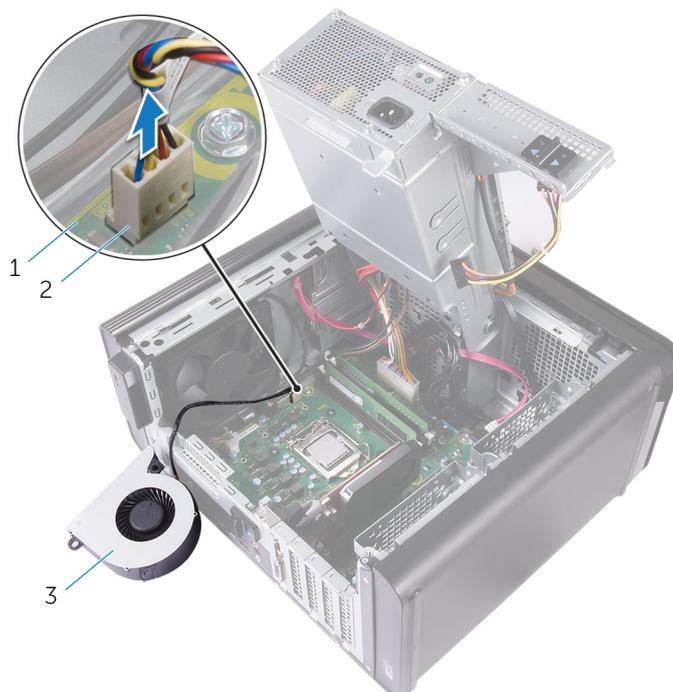
**Figura31. Remoção do cabo do ventilador**
