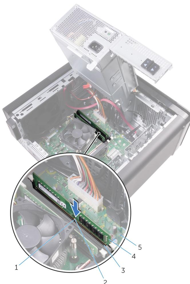
**Figura25. Substituir o módulo de memória**
